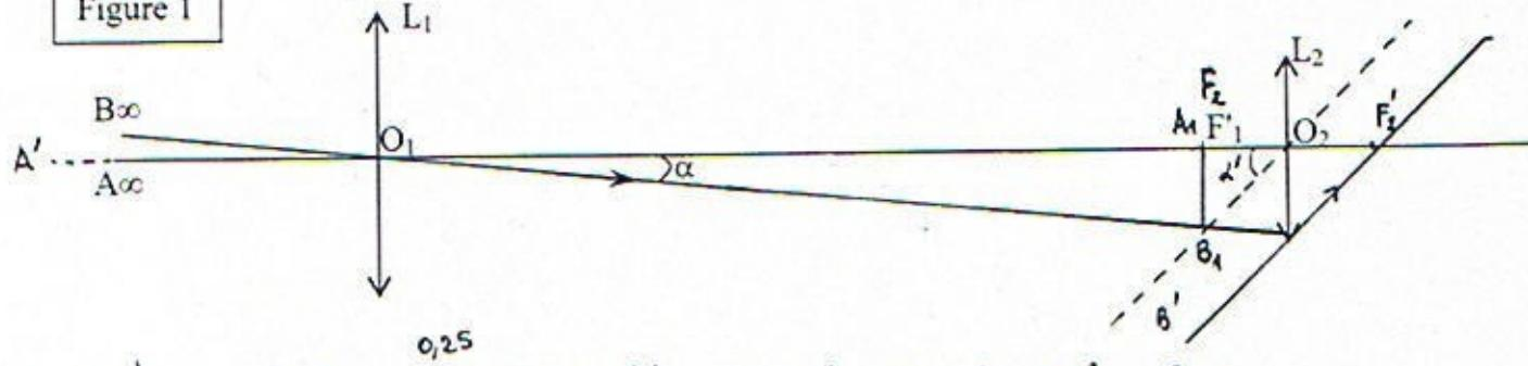
1-2-2  $\tan \alpha = \frac{A_1 B_1}{O_1 F_1'} \stackrel{0,25}{\Rightarrow} A_1 B_1 = \alpha \cdot f_1' = 9,3 \cdot 10^{-3} \times 1,00 = 9,3 \cdot 10^{-3} \text{ m} = 9,3 \text{ mm}$
