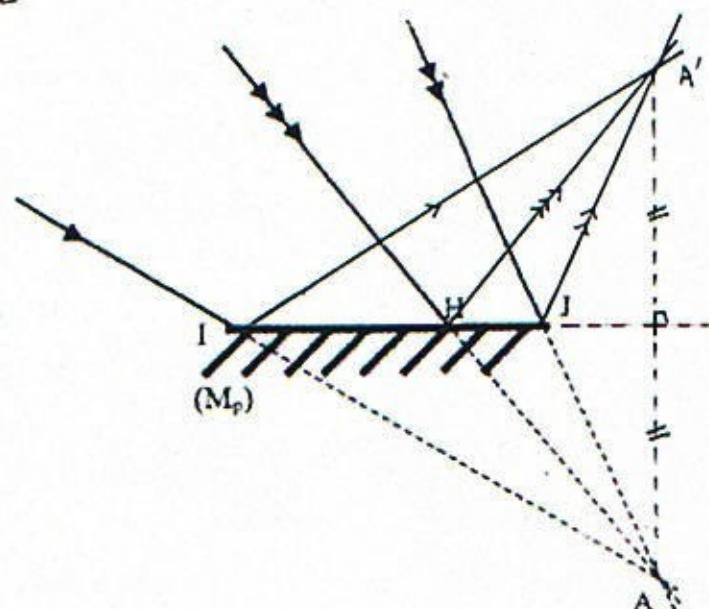
2-2-1 + 2-2-2 : B étant à l'infini, B<sub>1</sub> se trouve dans le plan focal du miroir sphérique
