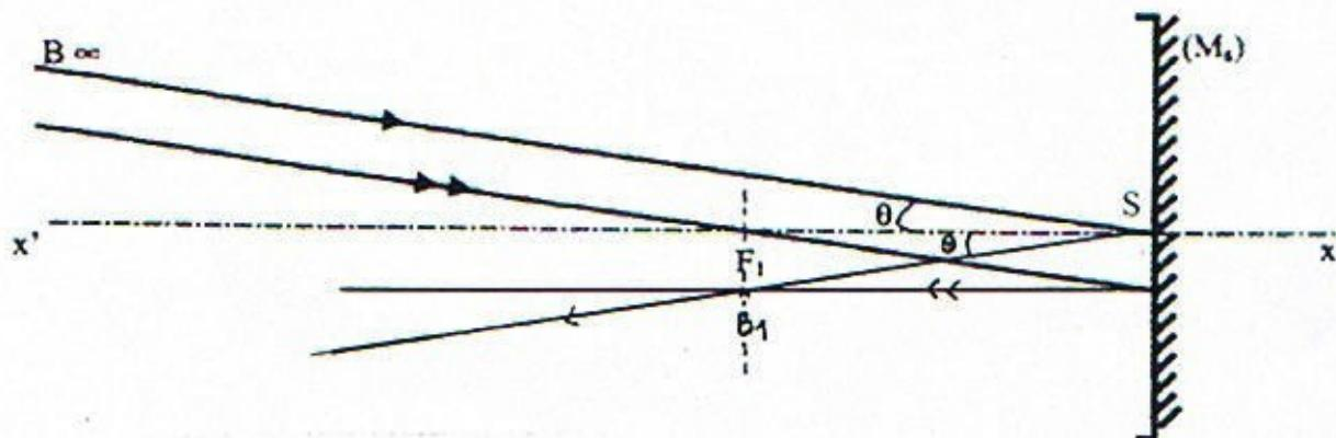
2-3.2  $A'B'$  à l'infini  $\Rightarrow A_2B_2$  se trouve dans le plan focal objet de  $L_2$   $\Rightarrow F_2$  confondu avec  $A_2$
